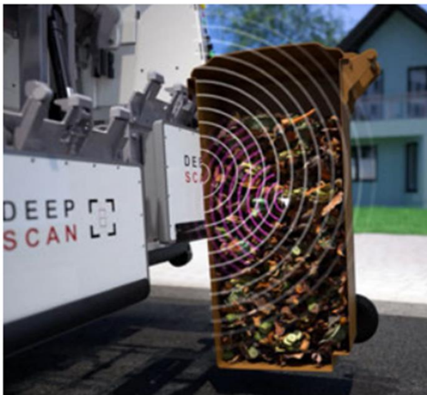
Störstofferkennung im Biomüll, Quelle: ZOELLER
