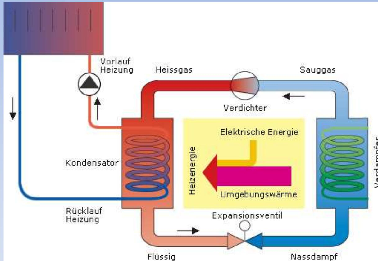
Prinzip der Wärmepumpe: Verdampfen/Kondensieren ↔ Thermodynamischer Kreisprozess
